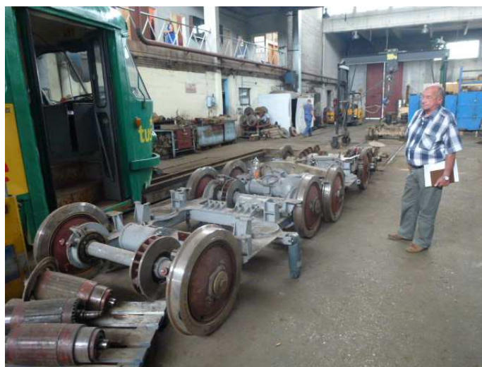
Obrázek 5 Podvozky dodané v rámci 1. etapy projektu - úprave kol
