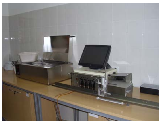
Obrázky 23 – 25: Laboratórne prístroje z USA BENTLEY 15 (analýza mliečnych zložiek).
