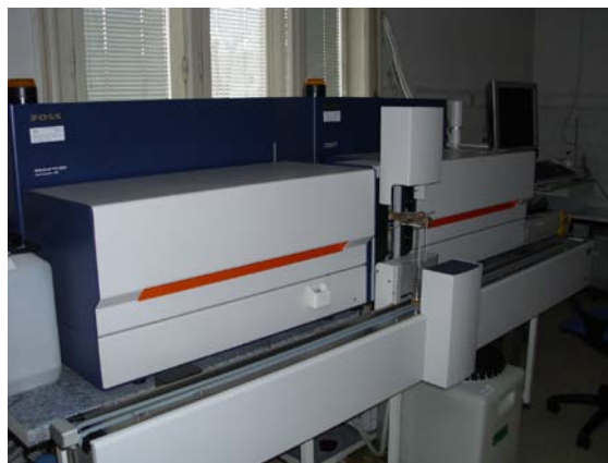
Obrázky 29 – 31: Laboratórne prístroje z USA od firmy BENTLEY na analýzu mliečnych zložiek, močoviny v mlieku a somatických buniek.
