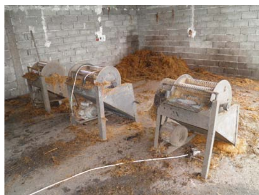
Obrázok 71: Poloautomatické zariadenia na lúpanie uvareného vrbového prútia, čím sa toto prútie zbavuje pre technologické proces nežiaducej kôry.
