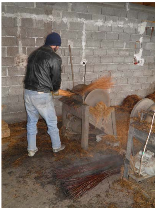
Obrázok 72: Práca na poloautomatickom zariadení určenom na odkôrenie uvareného vŕbového prútia je oproti ručnej práci oveľa jednoduchšia aj keď nie ešte úplne bez námahy.
