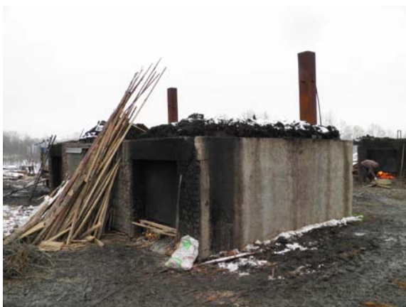
Obrázok 67: Kotle postavané z prostriedkov projektu a svojpomocne určené na varenie vrbového prútia.
