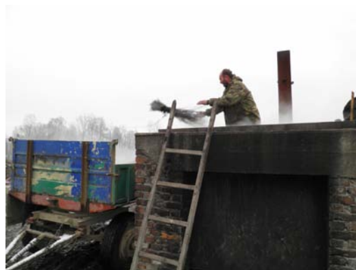
Obrázok 69: Detail na vyberanie uvareného vrbového prútia a jeho nakladanie na traktorový prívies.
