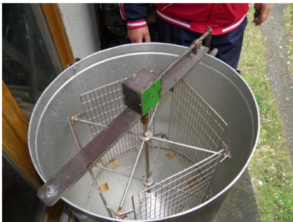
Obrázok 49: Jedna zo základných pomôcok včelára – medomet, v ktorom sa za pomoci odstredivej sily „vytáča“ včelí med z odviečkových voskových plástov v rámkoch.
