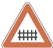
A 25 Železničné priesectie so závorami
