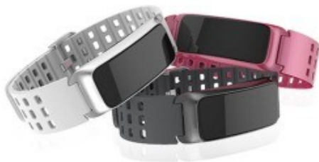
植入ECG芯片+PPG光电传感器
